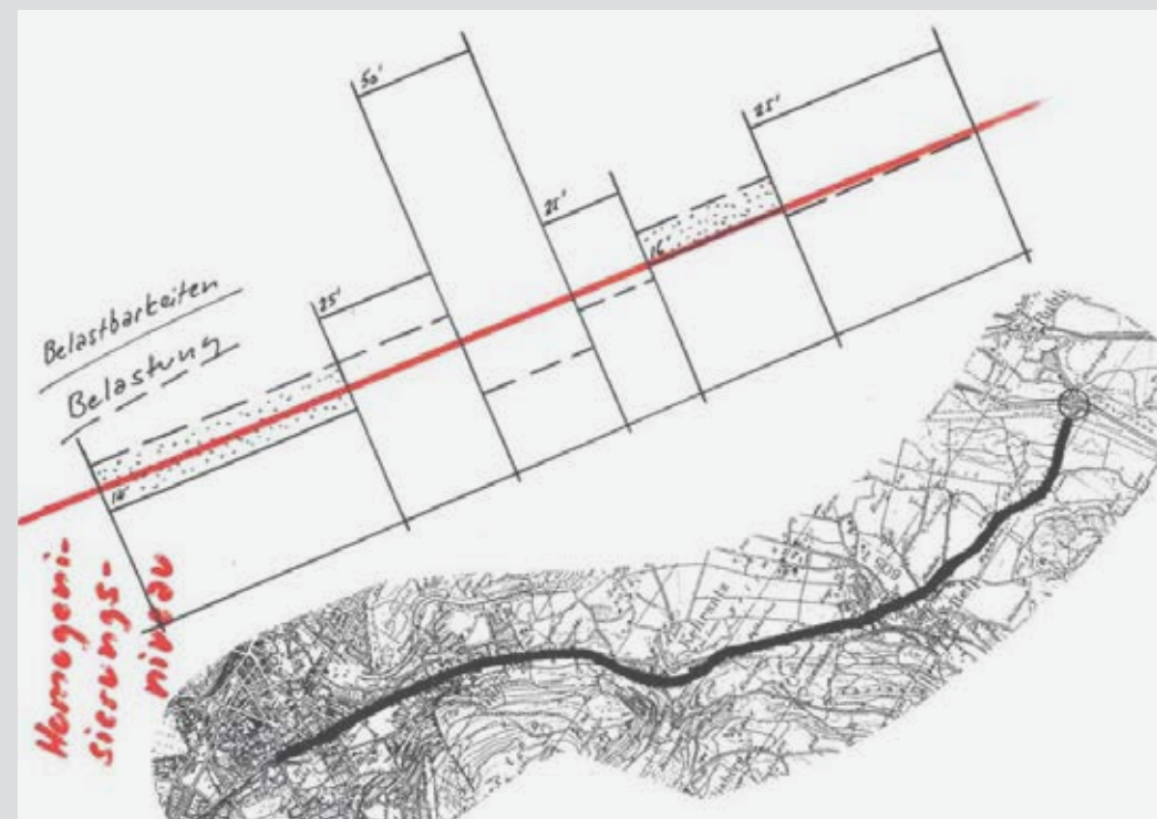
Beispiel für die Darstellung des Homogenisierungsniveaus unter Berücksichtigung von Belastungen und Belastbarkeiten (Quelle: „Nachhaltige Gestaltung von Verkehrsräumen im Siedlungsbereich“, BAFU, 2011)
