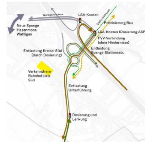
Grundidee neue Auslegung Anschlussstelle (verkehrlich grob geprüft)
